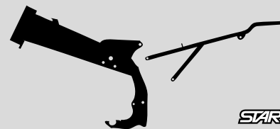
CADRE START POUR BRAS MONO ET AMORTISSEUR 270mm (BOUCLE AR. INCLUSE) START FRAME FOR MONO SWING ARM AND SHOCK ABSORBER 270mm (REAR SUBFRAME INCL.)
