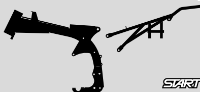
CADRE RENFORCÉ 88 POUR BRAS MONO (BOUCLE ARRIÈRE INCLUSE) 88 REINFORCED FRAME FOR MONO SWING ARM (REAR SUBFRAME INCLUDED)
